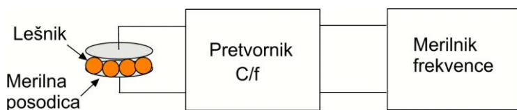
Slika 1. Blokovna shema merilnika.
